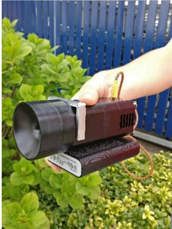
Figure : La capteur pollensniffer de poche
